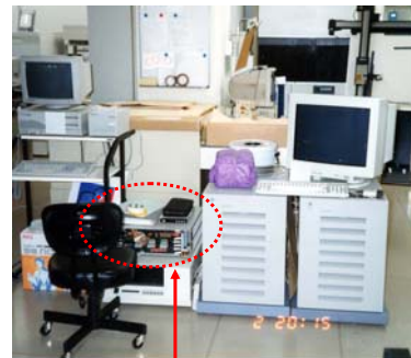
画像伝送ユニット JPEG圧縮、ISDNターミナル
